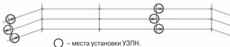
РИС. 3. Схема установки УЗПН на ВЛЗ 6-10 кВ для обеспечения возможности подключения переносных штанг заземления без установки на провода дополнительных зажимов
